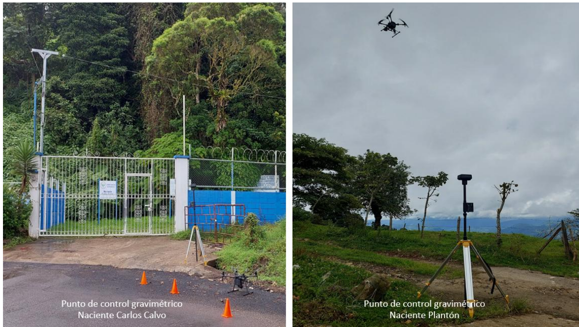
Imagen 1. La imagen muestra donde se fijaron los puntos de control terrestre para la toma de fotografías de las nacientes mediante el uso de RPAS. Tomadas el 11-7-2022.
